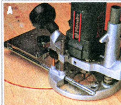
Д Вращая машинку вокруг закрепленного в заготовке центрирующего штифта, фрезеруют паз по окружности.
