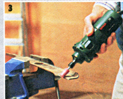
З Высокооборотный привод машинки используют и автономно для шлифования и полирования поверхности (фото 3).
